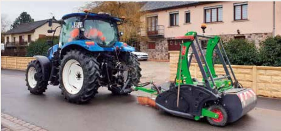
Dans ce cadre, la municipalité vient d'investir dans une **balayeuse hydraulique**. Pour optimiser cet équipement, le choix s'est porté sur un matériel s'adaptant sur le bras de relevage du tracteur agricole que possède le service technique de la commune. Il se monte et s'enlève rapidement, permettant ainsi de conserver toute la polyvalence du tracteur.
